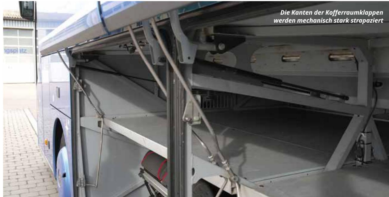
Die Kanten der Kofferraumklappen werden mechanisch stark strapaziert
